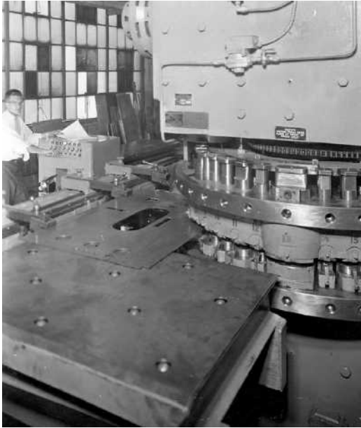
Abbildung 11: Wiedemann Revolver-Stanzpresse R101 um 1954 mit 3-achsiger Positioniersteuerung von GE 268
