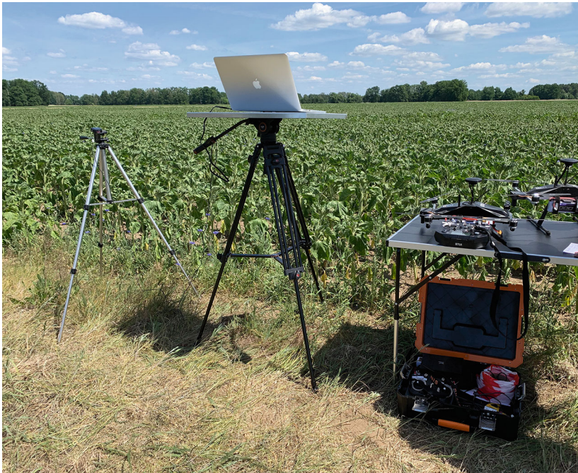
Abbildung 4.17 Mobile RTK-Bodenstation mit Steuertisch, Notfallsteuerung und Wartungsfläche
