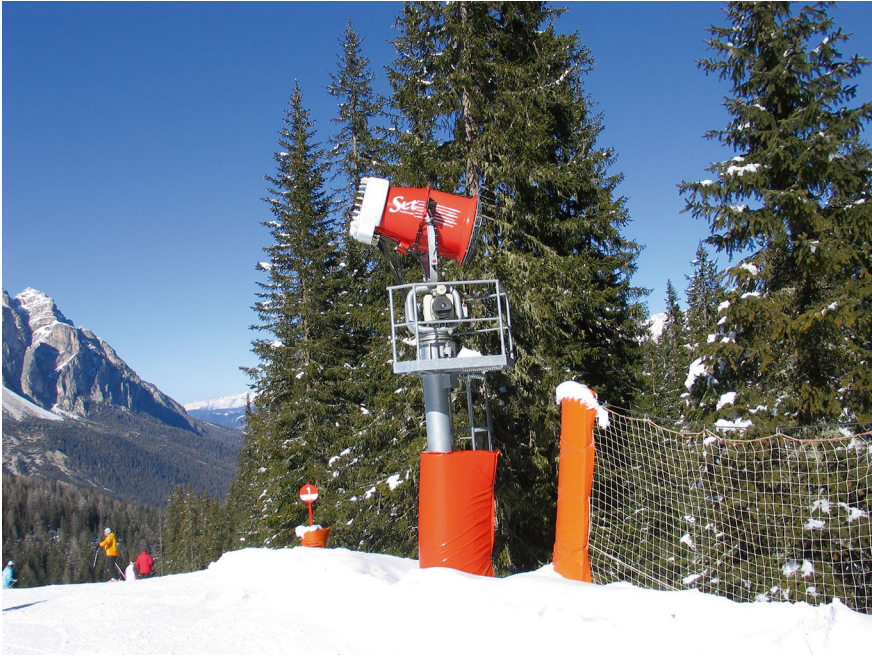
Abb. 3.21 Propeller-Schneeeerzeuger auf Turm. (C. Weiler)
