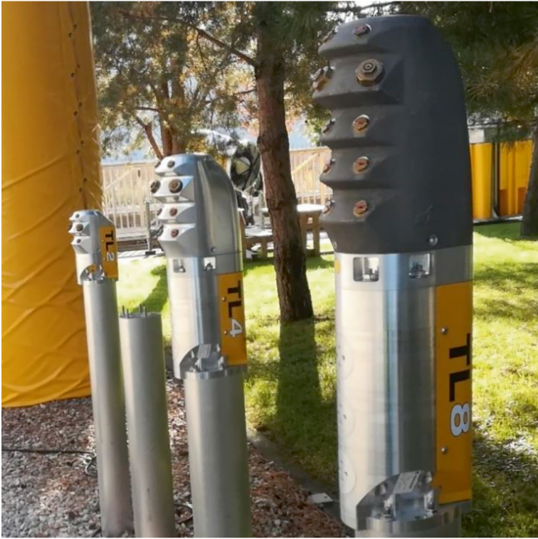
Abb. 3.4 Unterschiedlich geformte Lanzenköpfe von Schneilanzen. (C. Weiler)
