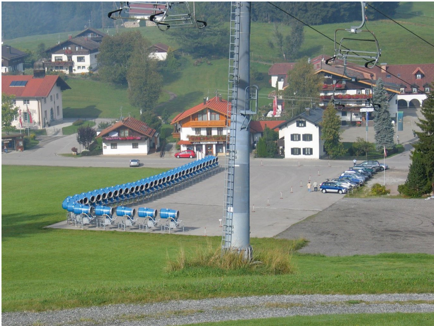
Abb. 3.23 Niederdruck-Schneekanone vor dem Transport ins Gelände. Durch das hohe Gewicht können beim Aufstellen und Versetzen Schäden an Vegetation und Oberboden entstehen. (C. Weiler)
