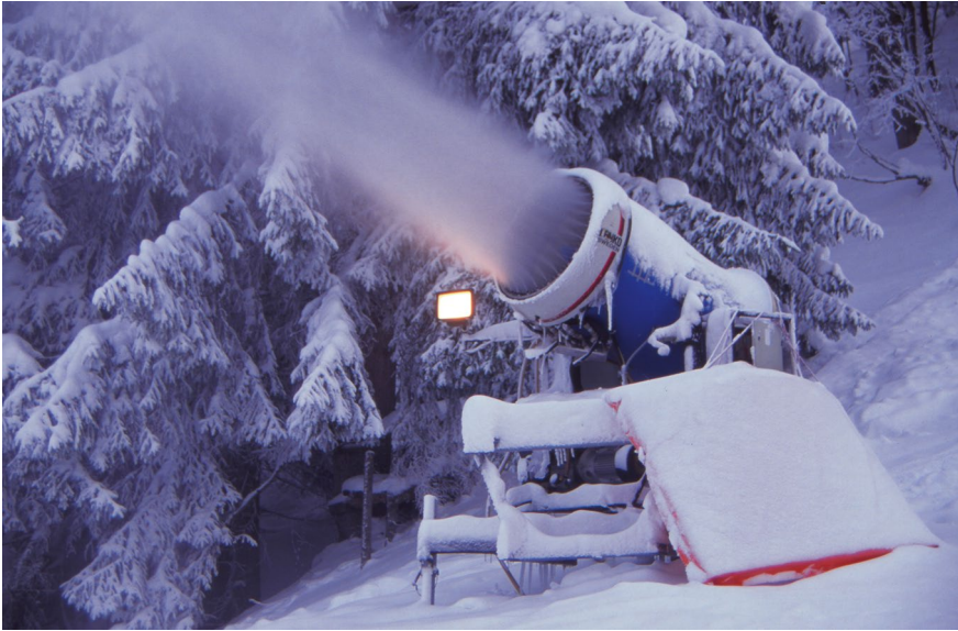
Abb. 4.38 Niederdruck-Schneeerzeuger mit Scheinwerfer. (U. Pröbstl-Haider)
