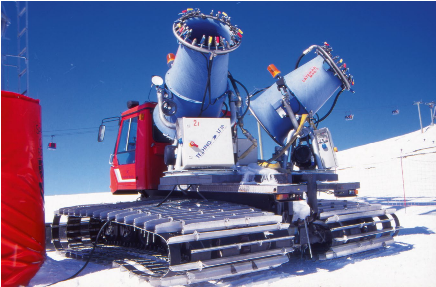
Abb. 3.2 Propellerkanonen auf einer Pistenraupe ermöglichen einen flexibleren Einsatz bei der Nachbeschneigung. (U. Pröbstl-Haider)
