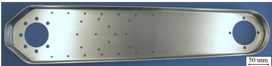
Bild 88: Mittels Tiefziehen und einer lokalen Wärmebehandlung aus AA1050 N8 hergestellte Außenschale eines Leichtbau-Roboterarms
