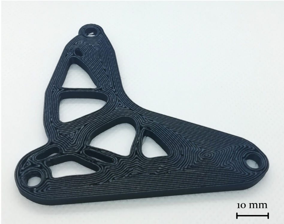
Bild 2.1: Bauteil des Autors, hergestellt im FLM-Verfahren (Extrusionspfadbreite für bessere Visualisierung der Bahnen reduziert) nach Topologieoptimierung, mit konzentrischem Innenmuster.
