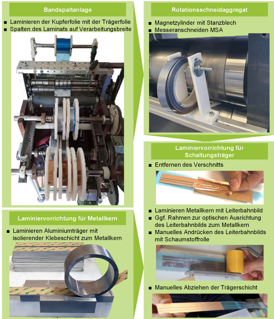
Bild 80: Versuchsanlagen und -vorrichtungen zur Herstellung des LED-Schaltungsträgers
