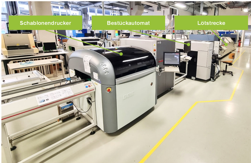
Bild 8r: Verwendete SMT-Fertigungslinie zur Bestückung der LED-Module [93]
