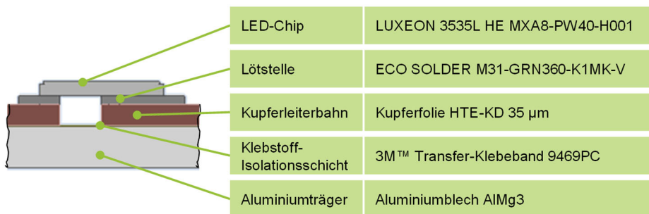
Bild 77: Lagenweiser Aufbau des LED-Moduls
