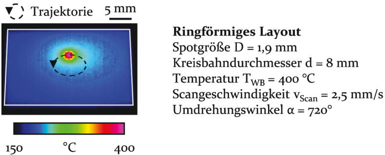
Bild 34: Exemplarische Temperaturverteilung für das ringförmige Layout bei der Retrogression einer Schliffprobe mit den Abmaßen 30 \times 30 \text{ mm}^2
