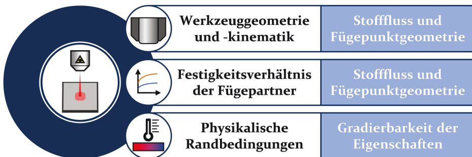
Bild 71: Limitierende Faktoren für die Applikation lokal begrenzter Wärmebehandlungen zur Steuerung des Stoffflusses beim mechanischen Fügen
