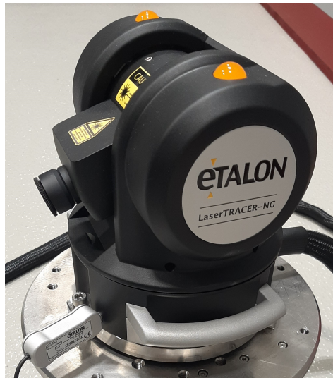
Bild 13: ‚LaserTRACER-NG‘ - ein nachführendes interferometrisches Längenmesssystem
