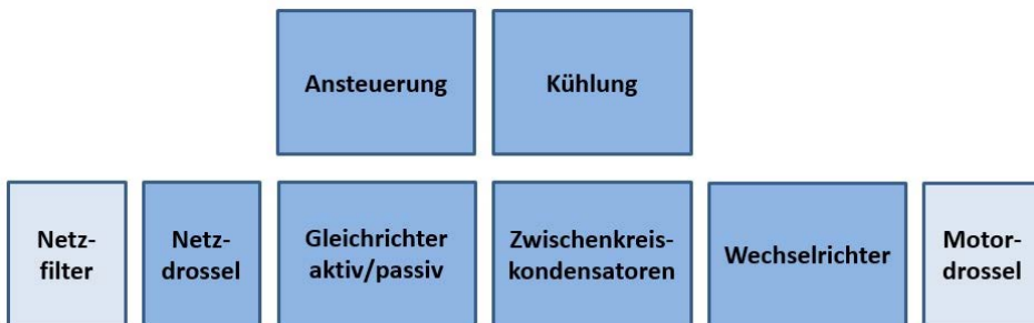
Bild 3: Verlustverursachende Komponenten eines Frequenzumrichters nach Norm DIN EN 50598-2:2014
