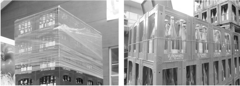
Abb. 2: Einwegfolie (links) und wiederverwendbare Schnur (rechts) zur Ladungssicherung
