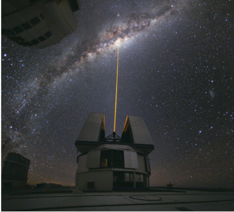
Abb. 12: Adaptive Optik kann Bildverzerrungen durch die instabile Atmosphäre ausgleichen. Wenn kein heller Leitstern zur Verfügung steht, kann das mit einem Laserstrahl ausgeglichen werden, der ein Referenzsignal in der Atmosphäre erzeugt.
