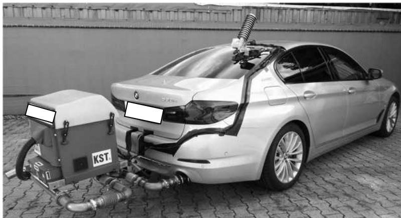
Abbildung 5-5: BMW 530e ausgestattet für portable Emissionsmessungen, Bild bereitgestellt durch KST Motorenversuch GmbH
