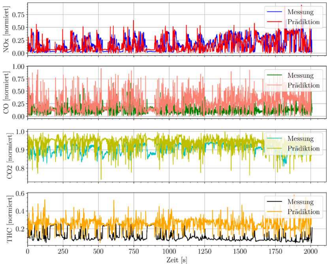
Abbildung 7-2: Vergleich zwischen Messung und Prädiktionswerten des physikalisch-phänomenologischen Imitationsmodells über den Testzyklus
