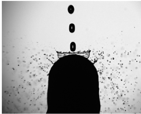
Abbildung 6.1: Aufprall einer monodispersen Tropfenkette auf einen abgerundeten Edelstahlprallkörper.
