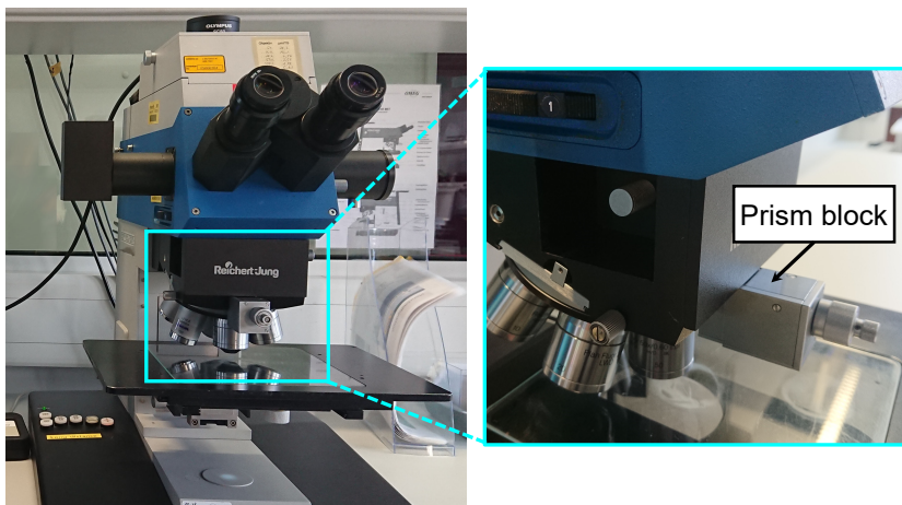
Fig. 3.5. Reichert-Jung Polyvar Met light microscope used for DIC method.
