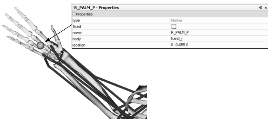
Bild 82: Definition von Körpermarken innerhalb der OpenSim-GUI. Die Körpermarken werden als Orts- und Richtungsvektoren von Endeffektoren interpretiert.
