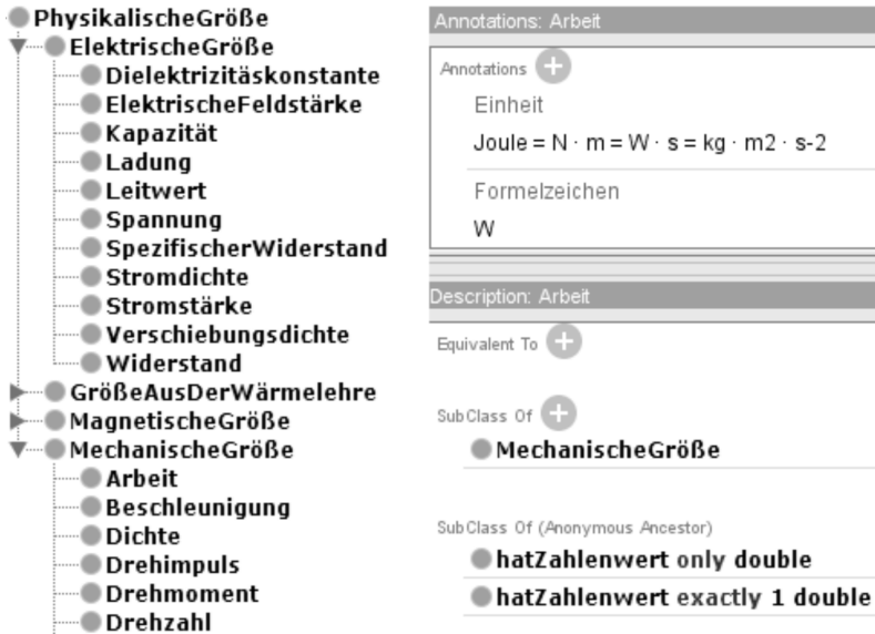
Bild 77: Partielle Darstellung von PhysikalischeGröße einschließlich eines Beispiels für Annotation sowie zugewiesener Properties, Screenshots aus Protégé [S1]
