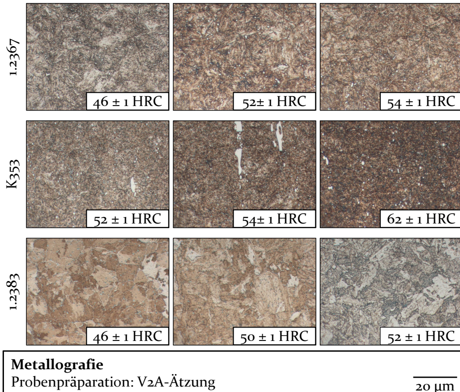
Bild 60: Einfluss der Wärmebehandlung auf das resultierende Gefüge der Werkzeugwerkstoffe
