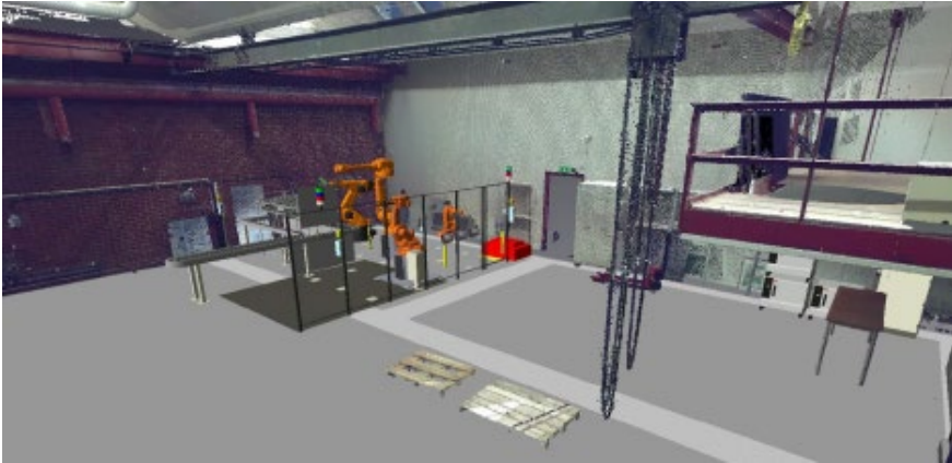
Bild 36: Hybridmodell aus Punktwolke (Gebäude) und CAD-Objekten (Fertigungs-ausrüstung) [149].
