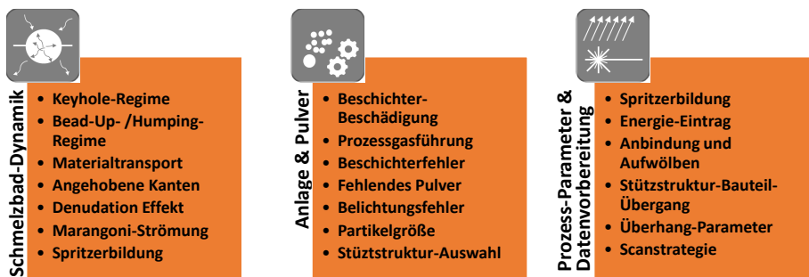
Bild 3: Ursachen der Oberflächenrauheit werden bezüglich der Schmelzbadynamik [17], der Anlagen-/Pulver-Randbedingungen [18], und der Prozess-Parameter [19] unterteilt.
