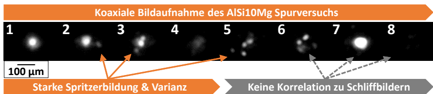
Bild 60: Einzelspurversuche mit dem Material AlSi10Mg sind aufgrund der starken Spritzerbildung und der hohen Varianz im Signal nicht verwertbar.
