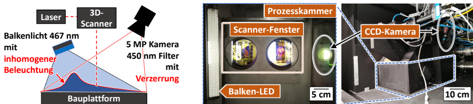
Bild 18: Aufbau laterale Kameraüberwachung QM-Coating: a) Schema und Probleme (rot); b) Innenansicht der Prozesskammerdecke (links) und Außenansicht (rechts).
