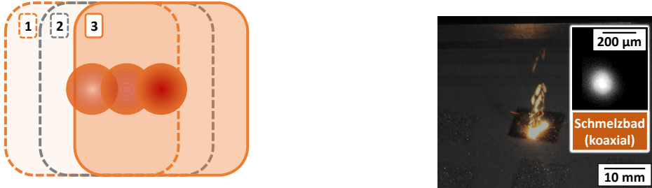
Bild 27: a) Die bei der Schmelzbad-Überwachung überstrichene Wegstrecke zwischen zwei Kamera-Aufnahmen entspricht der Größenordnung des Schmelzbades. b) Die Gasfackel streut die Laserstrahlung und die koaxial detektierte thermische Strahlung.
