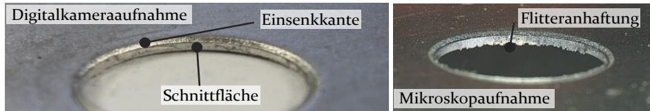
Abbildung 27: Einsenken- und Lochgeometrie des Trägerblechs
