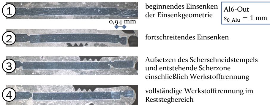
Abbildung 30: Stufenweise Darstellung des Einsenkprozesses mittels Schlibfbilder
