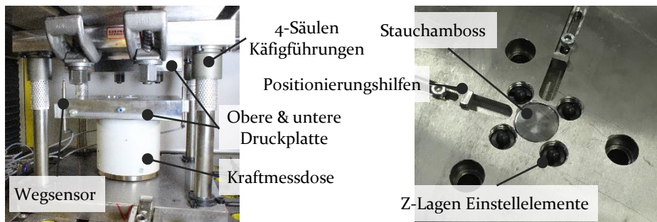
Abbildung 8: Stauchwerkzeug zum Stauchen der Hilfsfügeelemente in das vorgelochte Trägerblech
