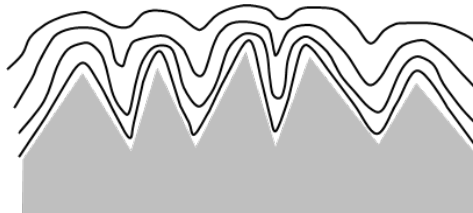
Bild 31: Abscheidung einer amorphen Kohlenstoffschicht auf einer rauhen Substratoberfläche. [Sal]
