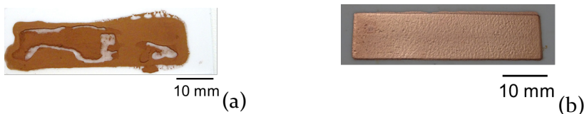
Bild 44: Exemplarische Darstellung der Ergebnisse des Partikeltyps B 1 mit zerflossenem Pastendepot sowie Fehlstellen nach dem Drucksinternprozess (a) und Typ C 2 (b) nach dem Drucksinternprozess
