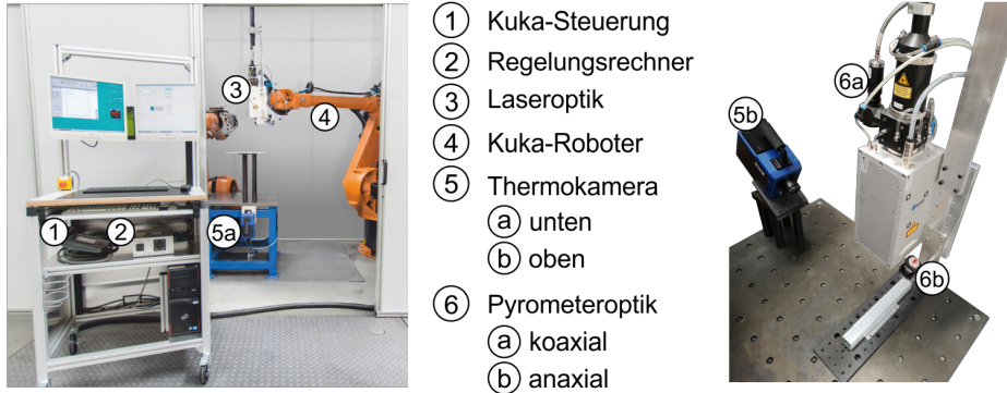
Bild 5: Laserzelle zur Kurzzeitwärmebehandlung
