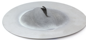
Bild 62: Verformte Probe nach Tiefung mit elliptischem Ziehring und stochastischem Muster
