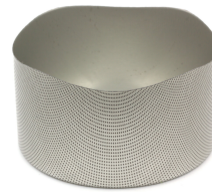
(b) Umgeformte Probe mit deterministischem Muster
