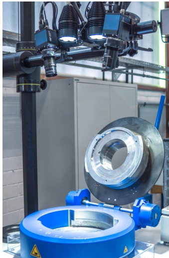
Bild 16: Erichsen Universalprüfmaschine mit optischen Dehnungsmesssystem ARAMIS, GOM
