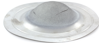
(b) verformte Probe mit stochastischem Muster
