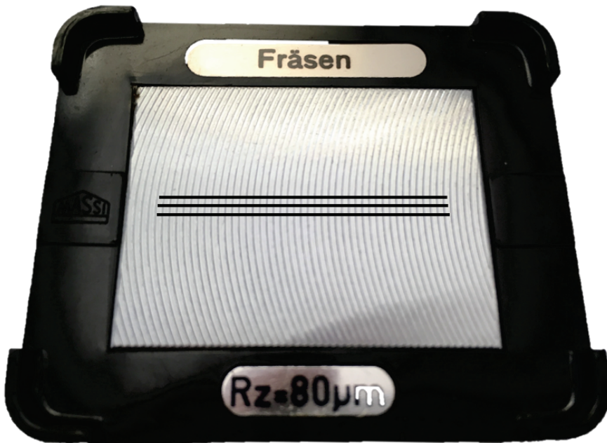
Bild 36: Oberflächenvergleichsnormal Stirnfräsen R_z = 80\text{ }\mu\text{m}
