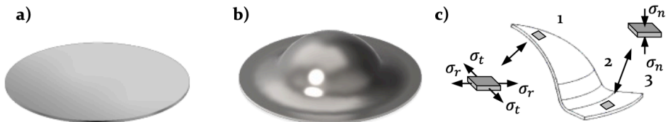
Abbildung 38: a) Blechrolle als Halbzeug für das Streckziehen, b) streckgezogener, halbkugelförmiger Napf, c) charakteristische Bereiche und dazugehörige Spannungszustände beim Streckziehen nach [7]
