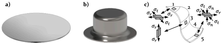
Abbildung 37: a) Blechrunde als Halbzeug für das Tiefziehen, b) tiefgezogener Napf, c) charakteristische Bereiche und Spannungszustände beim Tiefziehen nach [7]
