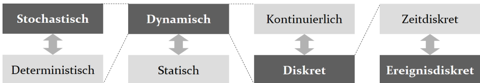
Bild 19: Klassifikation von Simulationsmodellen inklusive Verortung der ereignisdiskreten Materialflusssimulation in Anlehnung an [58]
