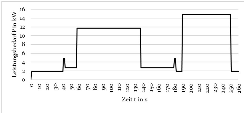
Bild 56: Leistungsbedarf der APA über der Zeit
