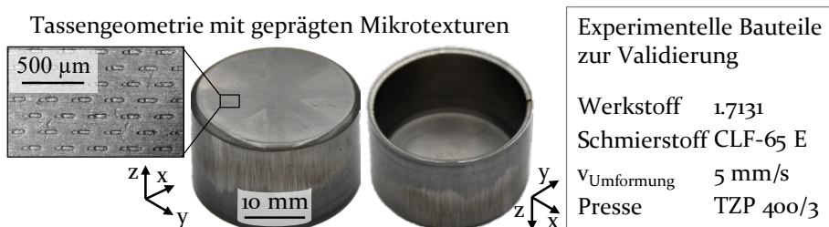
Bild 13: Durch kombinierte Umformung hergestellte Bauteile mit mikrogeprägten Texturen
