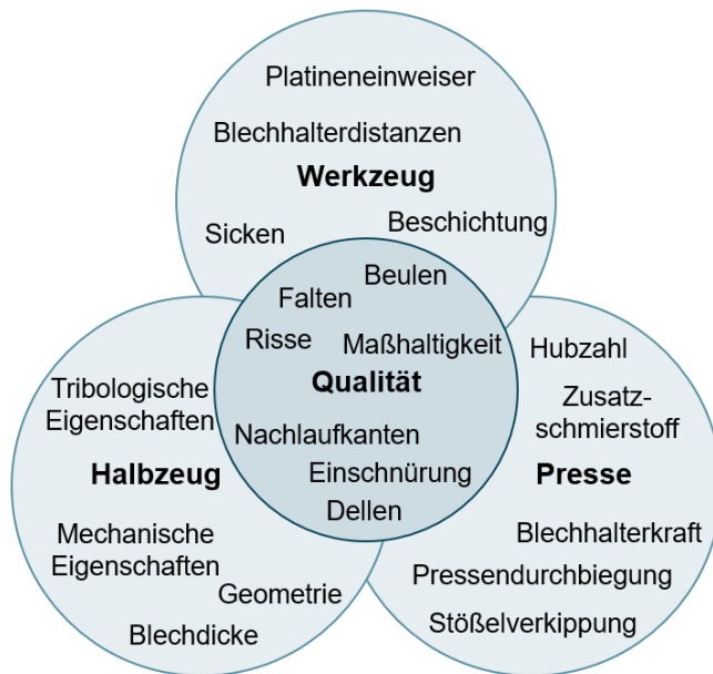
Bild 1: Wichtige Einflussfaktoren auf dem Umformprozess und Merkmale der resultierenden Bauteilqualität
