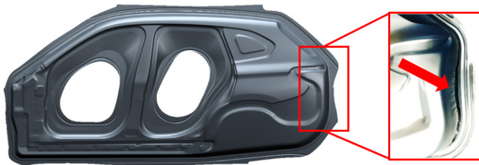
Bild 57: Exemplarische Darstellung des Bauteilbereichs am linken Seitenrahmen X 1 , an dem das Ziehteil gerissen ist
