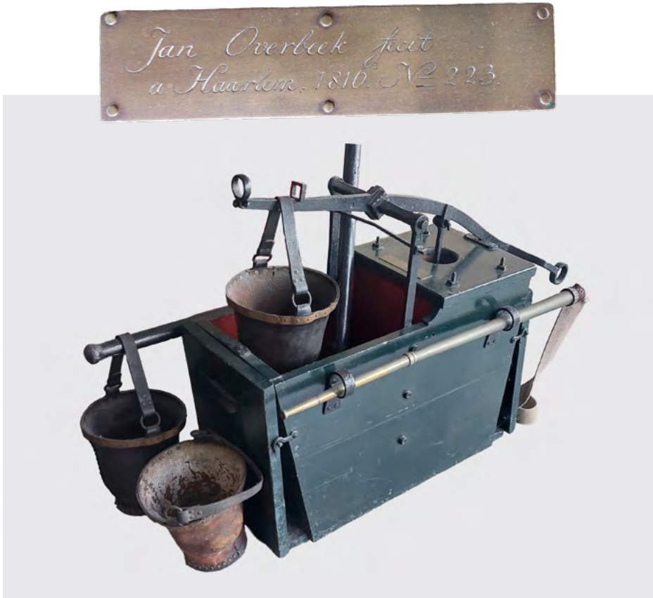
22 Nr. 4. Grotere 'draagbare' handbrandspuit met twee voetplanken en een pompstang voor een aan de ene kant een hefboom en aan de andere kant een pompstang voor twee pompbedienden. Jan Overbeek, Haarlem, 1816, naar Jan Paauw, Leiden, 1778. Foto Ton Markwat.
