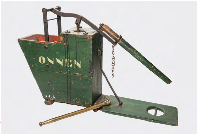
12 Nr. 9. Draagbare handbrandspuit van de gemeente Onnen. Jan Overbeek en Karl (Carel) Gerber, Haarlem, voor of begin 1823, naar Jan Paauw, Leiden, 1778.
